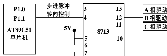
图2 脉冲分配器与单片机的接口原理框图
