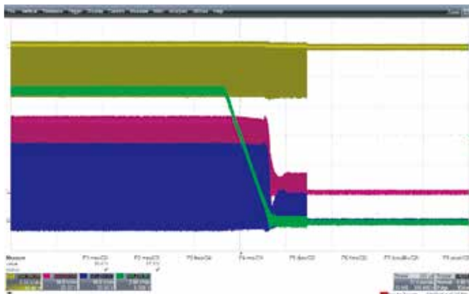
图17. 有源钳位吸收器条件下软启动期间的SR漏极波形
