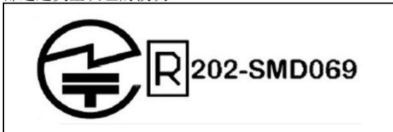
在BM71 模块上，由于受限于模块尺寸（9.0 mm x 11.5 mm），日本标识符仅在数据手册中显示，而不能在模块标签上显示。内部使用该模块的最终产品必须贴有一个标识以指代其内部通过类型认证的模块：
