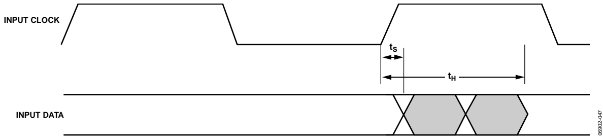
图46. 设置和保持时间相对于锁存时钟沿延迟( t_s 为负值, t_H 均为正值)
