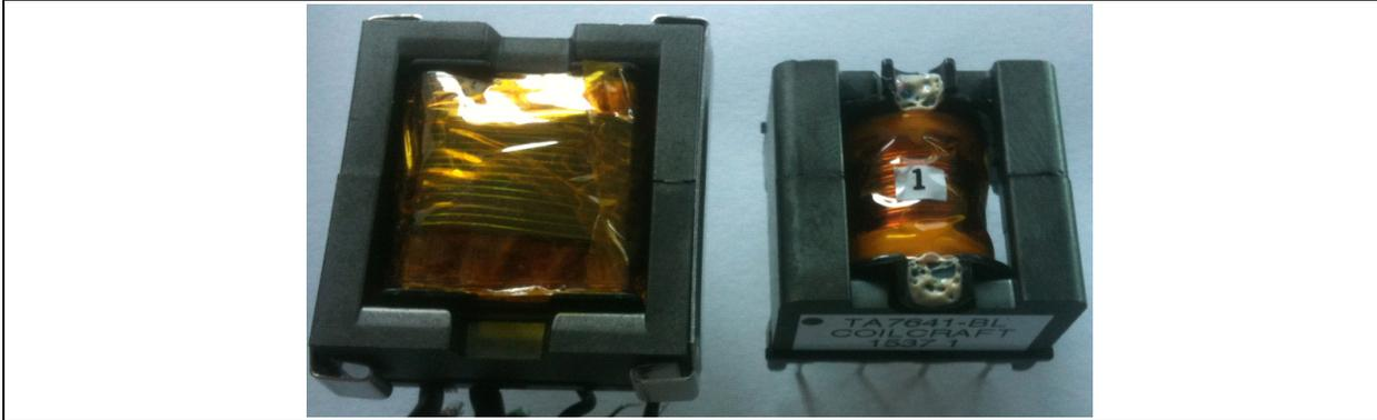
联系专业变压器绕组公司的优势在于他们拥有经验和工具；好工具可以通过良好耦合来最大程度降低漏电感，经验可以使最终成品的尺寸最小化，此外或许还能有其他方面的优化。
