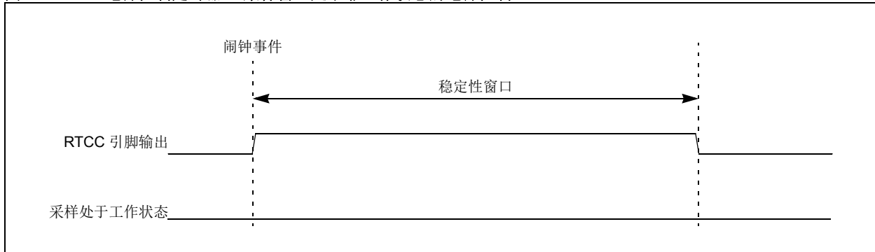
图 28-11： 电源控制定时器（采样窗口处于非工作状态的电源控制）
