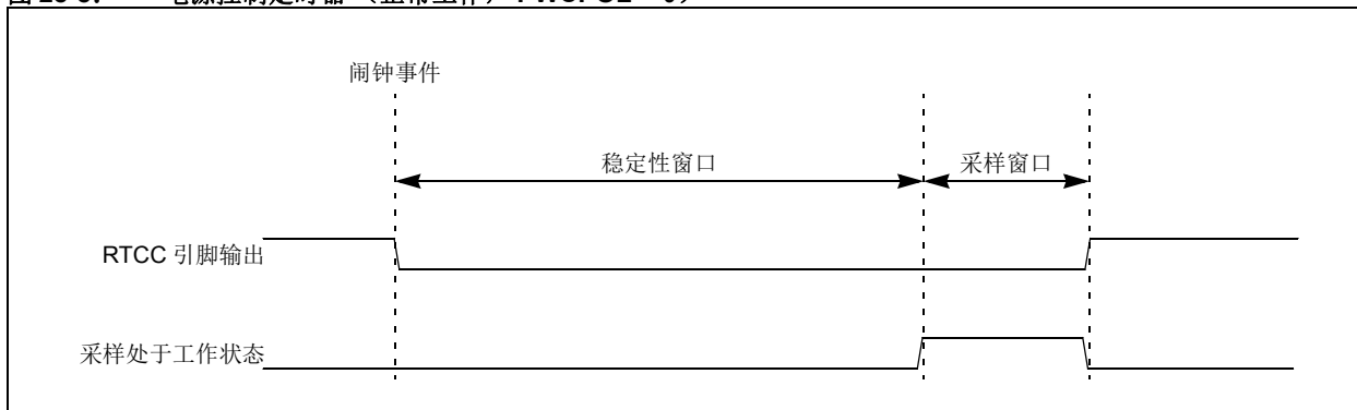
图 28-8: 电源控制定时器（正常工作，PWCPOL = 0）
