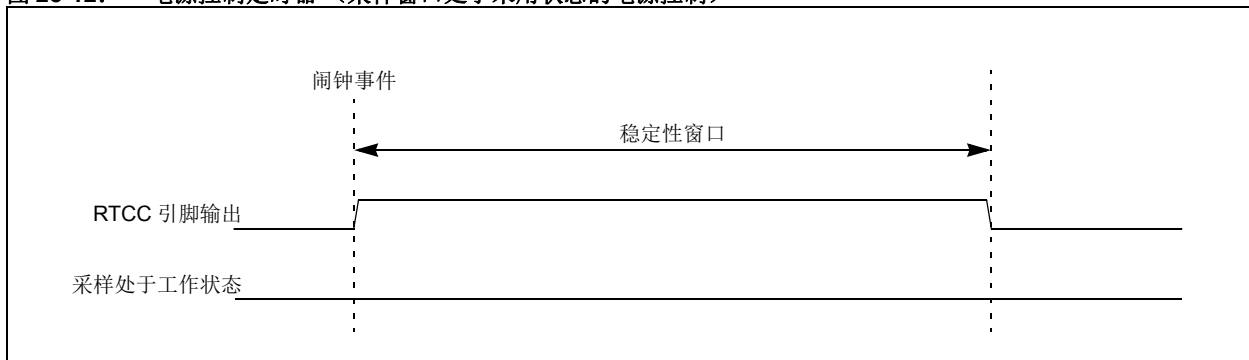
图 28-12： 电源控制定时器（采样窗口处于未用状态的电源控制）
