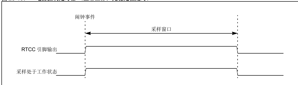
图 28-10: 电源控制定时器（正常工作，无稳定性延时）
