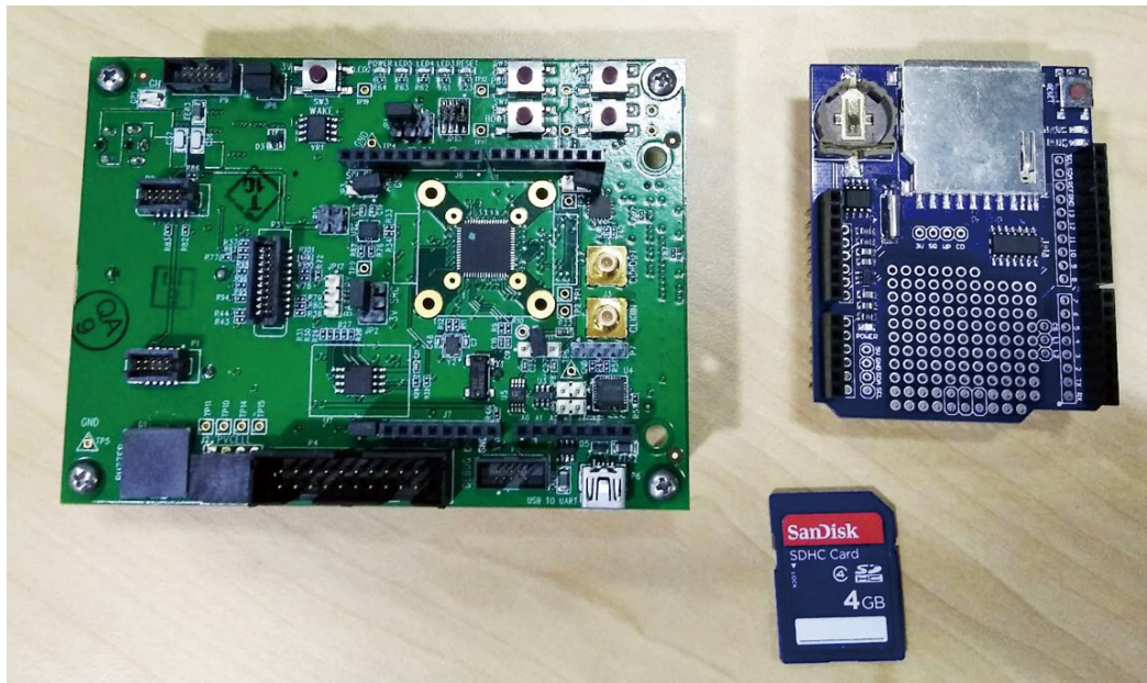
图1. 所需电路板: EVAL-ADuCM3029 EZ-KIT评估板(左侧), 与Arduino兼容的SD卡扩展板(右上方), SD卡(右下方)
