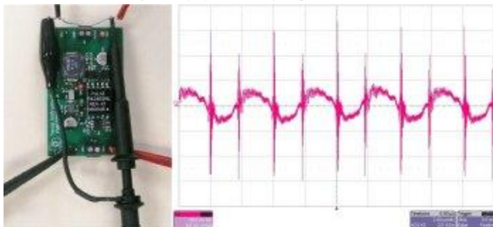
图 1 错误的纹波测量得到的较差的测量结果
