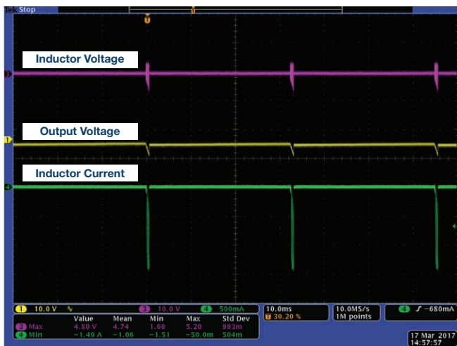
图4. 打嗝模式下的ADP5071反相稳压器
