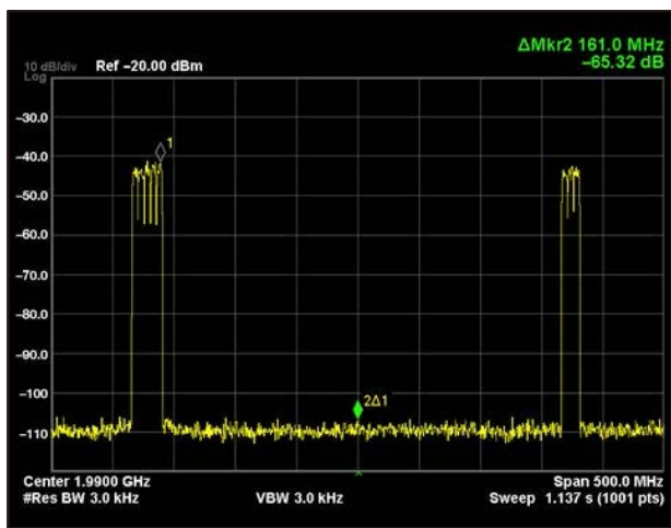
图4. 双频段WCDMA信号（1.8 GHz和2.1 GHz频段）。
