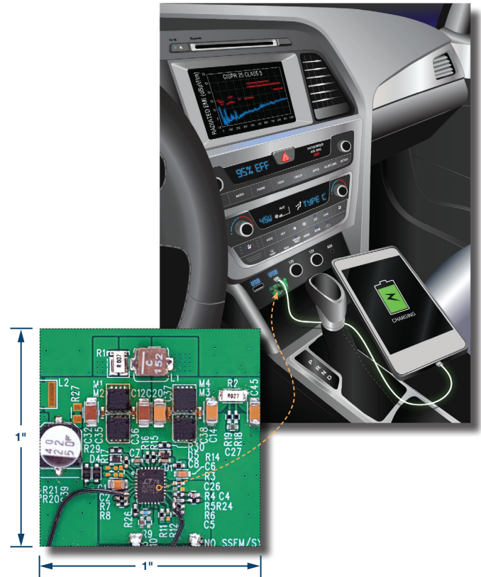
图1. 1平方英寸大小的高效率、低EMI USB Type-C电源解决方案。
