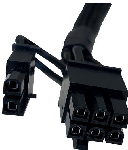
图 9: 6 针与 8 针 PCIe AUX 电源连接器线示例
