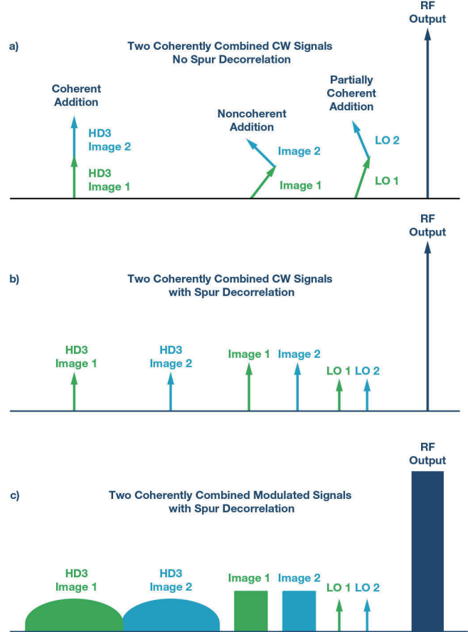
图3. 用频率显示杂散信号的光谱示例。三个示例：(a) 无杂散去相关的两个组合CW信号；(b) 强制杂散去相关的两个组合CW信号；以及(c) 强制杂散去相关的两个组合调制信号。
