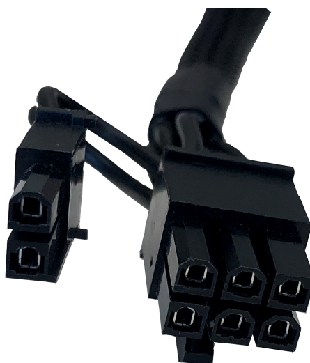
图 9: 6 针与 8 针 PCIe AUX 电源连接器线示例
