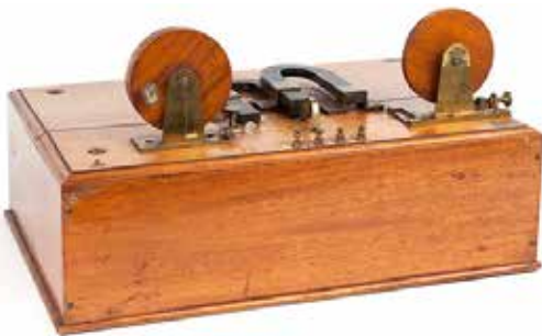
图9. 像马可尼那样使用的磁检波器。 3
