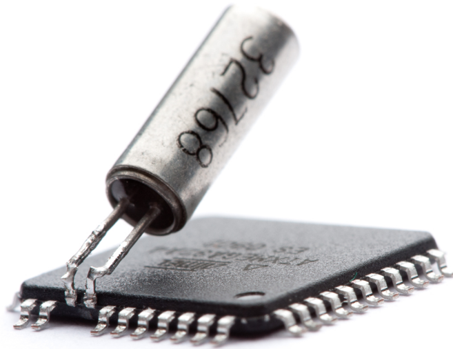
图 3-2. 晶振直接焊接到弯曲的 XTAL/TOSC 引脚上
