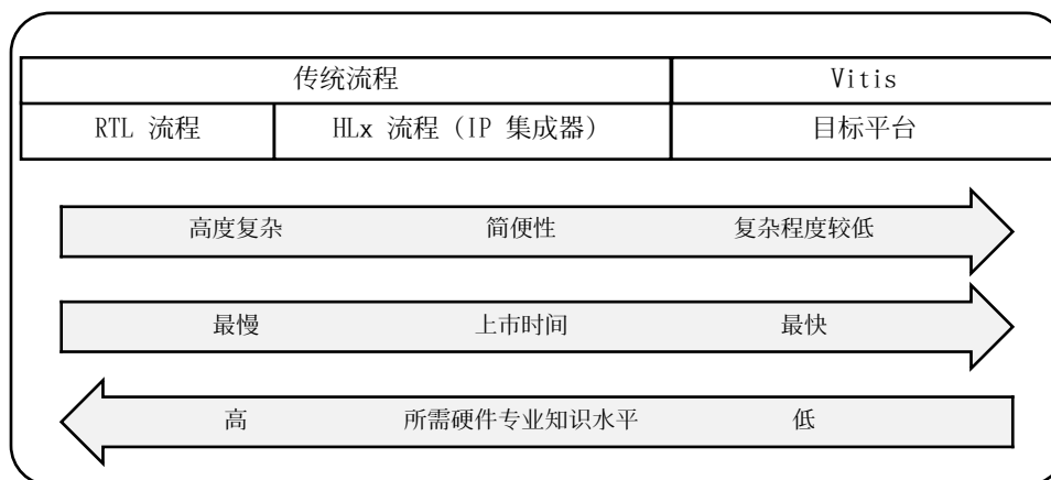
图 3: Alveo 数据中心加速器卡设计流程
