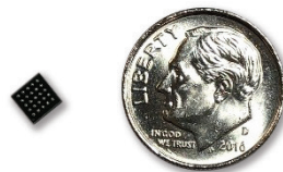
图1. LTM8074使用Silent Switcher ® 架构，实现完整的小型封装低噪声解决方案。
