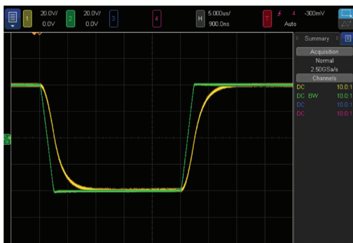
图8. 对中等输入压摆率( \pm 32 V/ \mu s)的大信号响应
