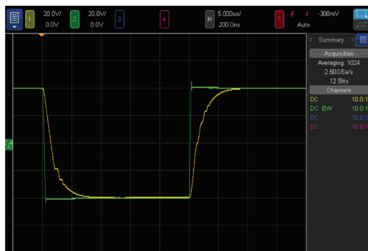
图9. 对过载输入压摆率( \pm 130 V/ \mu s)的大信号响应
