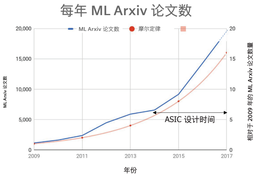
图 2：ASIC 设计时间与每年的机器学习论文数量 (图片提供方：Samba Nova；改编自 Jeff Dean, Scaled ML)
