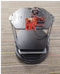
图 9. IWR1443 BOOST 安装在 Turtlebot 2 上的 EV M。
