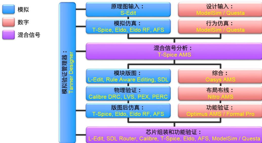
图 5: Tanner 为模拟 / 混合信号设计与验证提供一个自上而下的设计流程。
