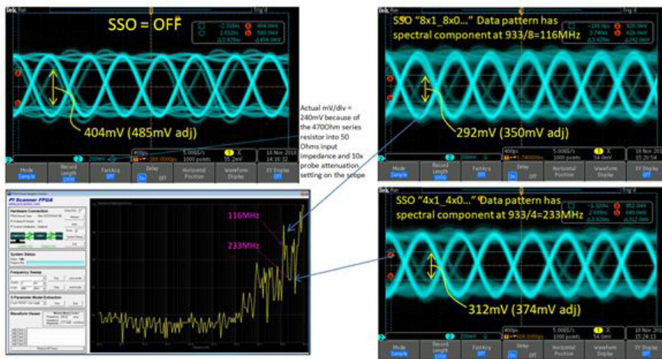
图 20. 在包含和不含 SSO 数据模式的情况下，在 PCB 上的 DRAM 过孔处测量的 DDR4 DQ4 眼开度
