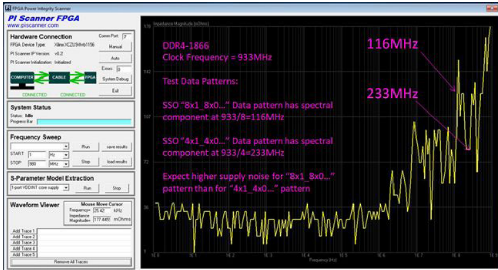
图 18. 具有与共振峰和“深”阻抗对齐的频谱分量的 SSO 数据模式
