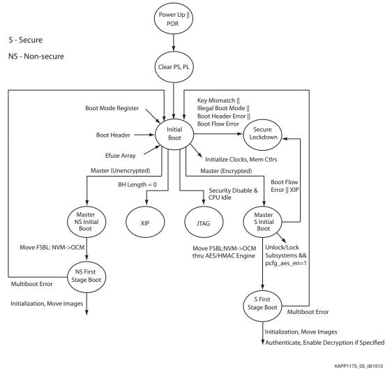
Figure 4: BootRom Code Flow Diagram
