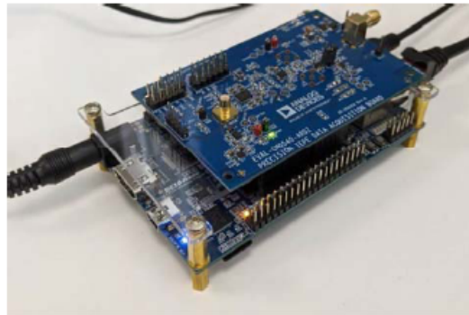
图18.EVAL-CN0540-ARDZ安装在Terasic DE10-Nano载板上
