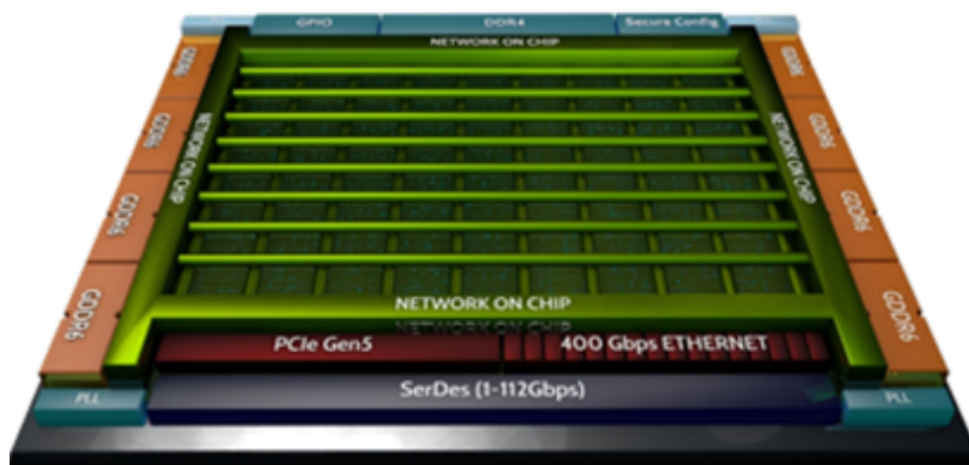
图 5: Achronix 高性能 FPGA 器件 Speedster AC7t1500 的架构
