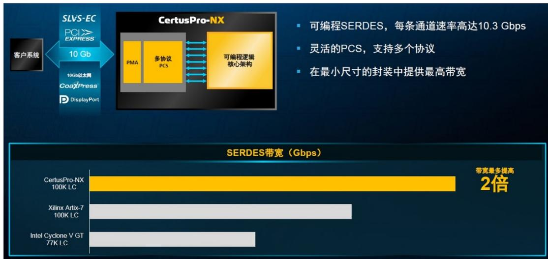
同时，为满足网络边缘 AI 和机器学习应用对稳定的数据协处理的需求，CertusPro-NX FPGA 支持多达 100K 逻辑单元，是目前所有基于 Nexus 的 FPGA 中逻辑密度最高的器件，其片上存储器容量也比同类其他 FPGA 高出约 65%，是目前唯一支持 LPDDR4 DRAM 存储标准的低功耗 FPGA。此外，CertusPro-NX 在可编程架构基础上还增加了超高效的 DSP 模块，以及小型和大型内部存储器模块，用于支持人工智能和机器学习应用中的低延迟数据处理。
