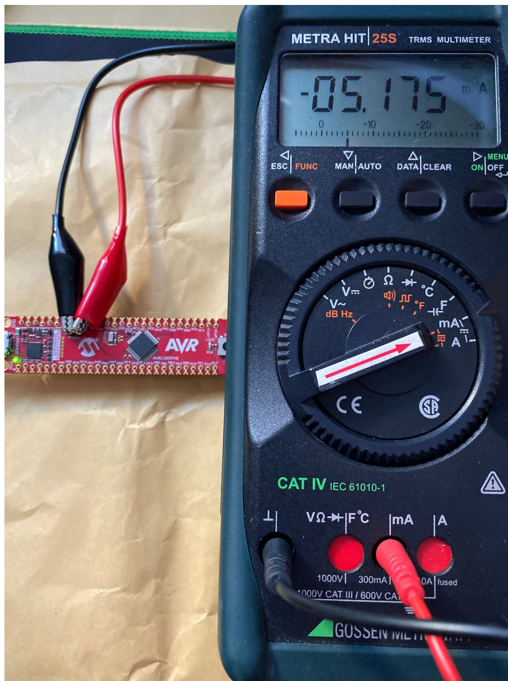
图 3-1. 通过设置万用表读取电流
