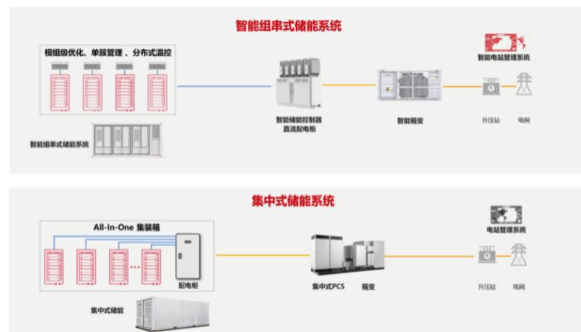
图12: 组串式储能系统对比集中式储能系统
