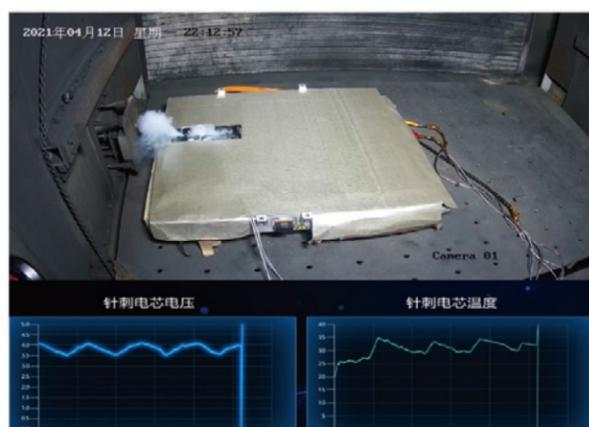
图14:磷酸铁锂电芯针刺试验
