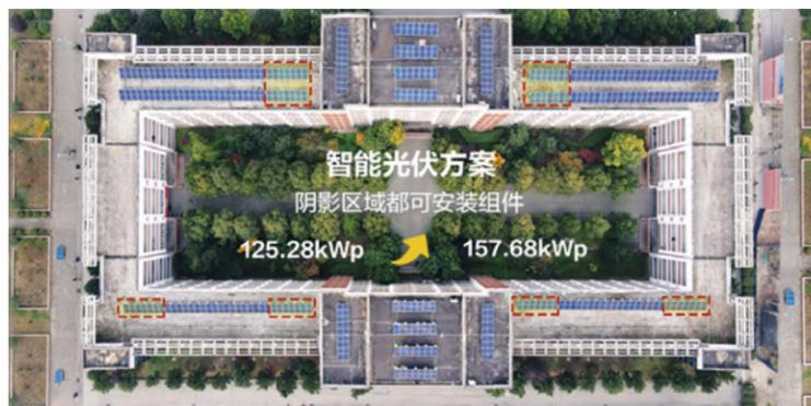
图10: 库庄中学屋顶光伏装机量对比
