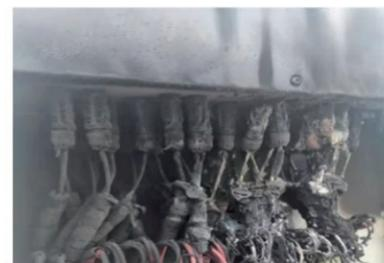
图 20: 案例3 直流端子虚接过热烧毁
