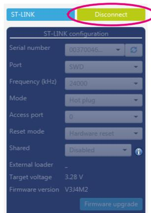
在这一步中，由于 RDP 级别更改后执行的入侵检测，器件处于冻结状态。因此，与器件之间的连接丢失。按照第 10.5.3 节中描述的程序（JP3 跳线（IDD）开路 and 闭合）从入侵检测中恢复。
