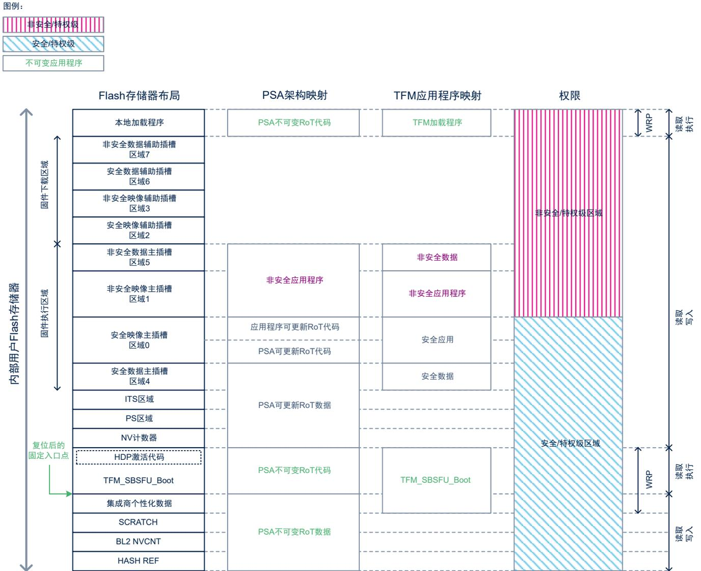
在为了跳转到安全应用程序而离开 TFM\_SBSFU\_Boot 应用程序时，所有专用于执行 TFM\_SBSFU\_Boot 的 Flash 存储区域均被隐藏，安全和非安全主插槽区域允许执行。
