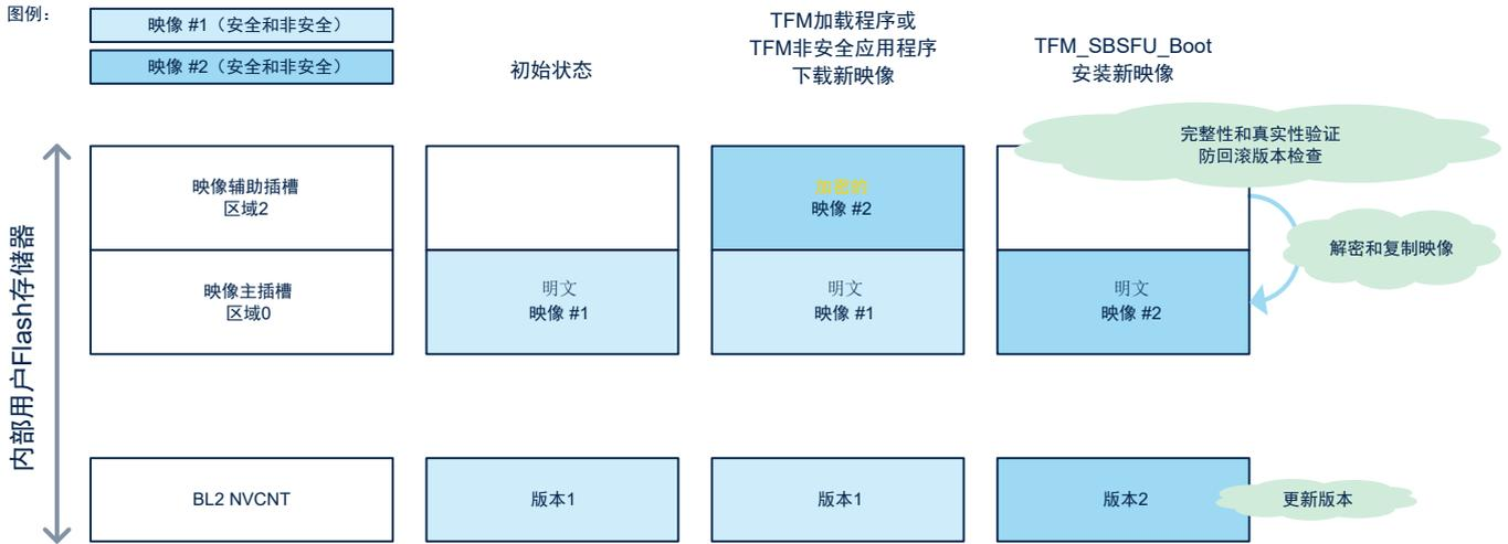
图 14. 单固件映像配置和仅主插槽配置下覆盖模式的新固件下载和安装流程
