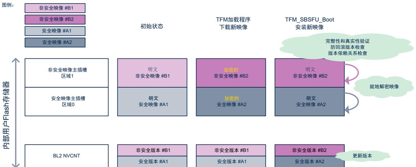
图 13. 单固件映像配置以及主和辅助插槽配置下覆盖模式的新固件下载和安装流程
