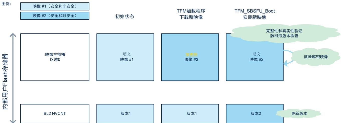
图 15. 交换模式的新固件下载和安装流程（有映像确认）
