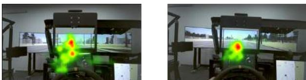
图 2-8 AR-HUD 眼动热点模拟实验：AR-HUD 关闭（左图）vs AR-HUD 开启（右图）
