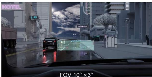
图 3-24 AR-HUD 不同 FoV 显示 AR 导航示意图
