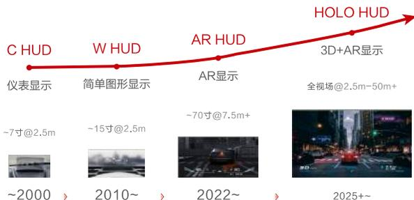
图 2-18 车载抬头显示的代际定义
