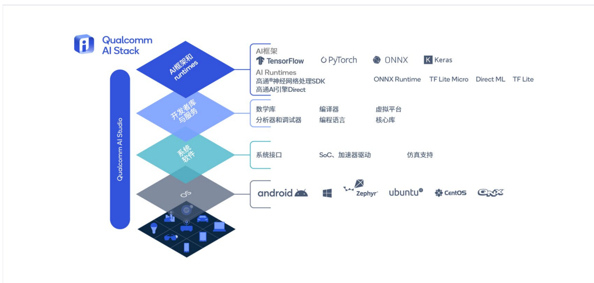
图3：高通 AI 软件栈旨在帮助开发者一次编写、随处运行，实现规模化部署。
