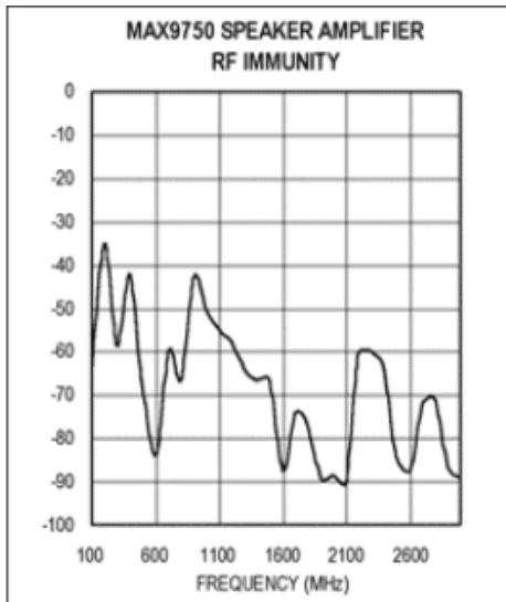
图 C. MAX9750 RF 抑制测试结果。
