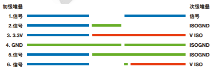
图 1. PCB 层堆叠示例。
