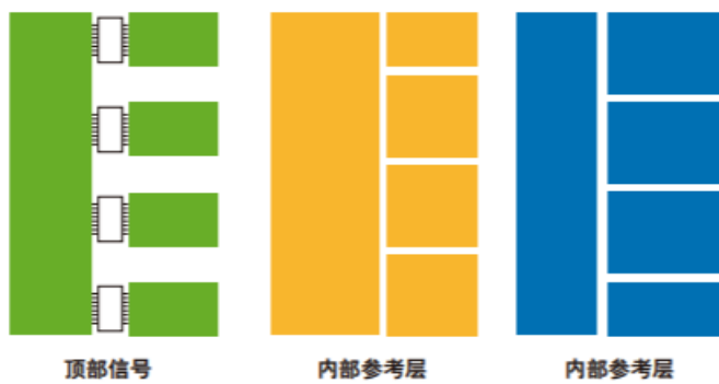
图 2. 具有交叠拼接电容的四个相邻通道。
